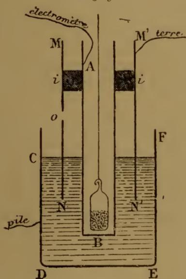
MNM'N', relié au sol, sert de tube de garde pour empêcher le passage du courant à travers l'air. Une ampoule contenant le sel de baryum radifère peut être placée au fond du tube AB; les rayons agissent sur le liquide après avoir traversé le verre de l'ampoule et les parois du tube métallique. On peut encore faire agir le radium en plaçant l'ampoule en dessous de la paroi DE.
